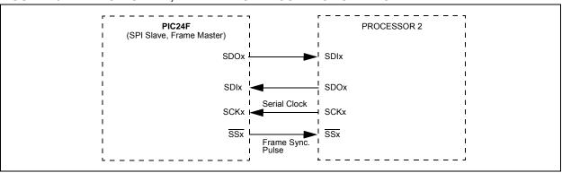
FIGURE 15-8: SPI SLAVE, FRAME SLAVE CONNECTION DIAGRAM
